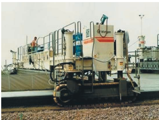
Figura 4 – Texturização mecânica longitudinal com lona
