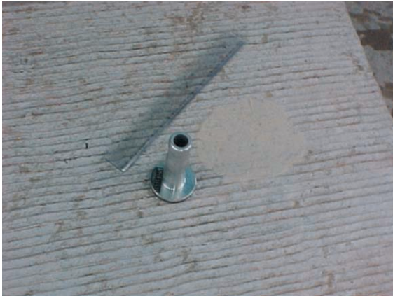
Figura 12 – Ensaio da mancha de areia, para verificação da textura superficial.
