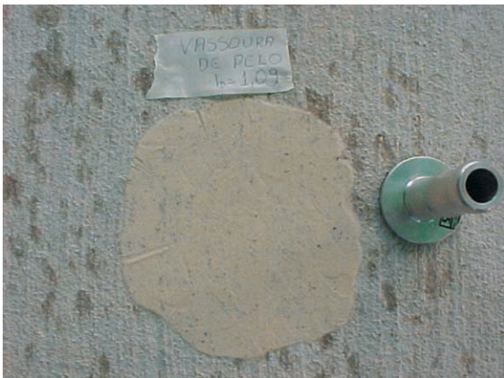
Figura 13 – Detalhe do diâmetro da mancha de areia, a ser medido em quatro pontos.
