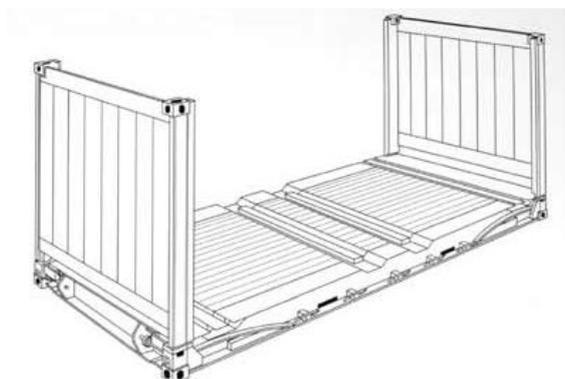
FIGURA 2.7 — ESQUEMA DE UM *CONTAINER FLAT RACK*
