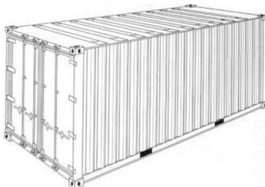
FIGURA 2.4 — ESQUEMA DE UM *CONTAINER DRY BOX*
